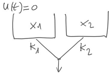
$$\begin{aligned} \dot{x}_1 &= -k_1 x_1 \\ \dot{x}_2 &= -k_2 x_2 \\ y &= k_1 x_1 + k_2 x_2 \end{aligned} \quad A = \begin{bmatrix} -k_1 & 0 \\ 0 & -k_2 \end{bmatrix} \quad \left| \quad c^T A = \begin{bmatrix} k_1 & k_2 \end{bmatrix} \begin{bmatrix} -k_1 & 0 \\ 0 & -k_2 \end{bmatrix} \right.$$
