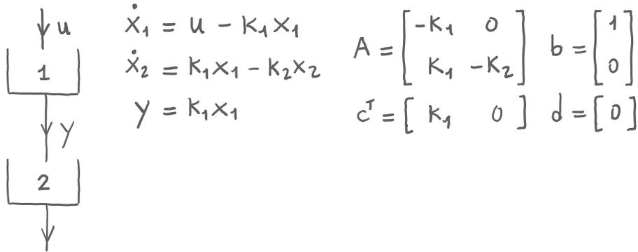
Nota 1: la variabile d'uscita  $y$  è la portata uscente dal serbatoio 1. Dal punto di vista fisico, la portata uscente dal serbatoio 2 è l'uscita del sistema, nel senso di acqua che abbandona il sistema, ma non viene misurata.
