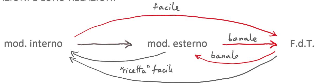
FUNZIONE DI TRASFERIMENTO (F.d.T., ce n'è una per ogni coppia  $(y_i, u_j)$ )
