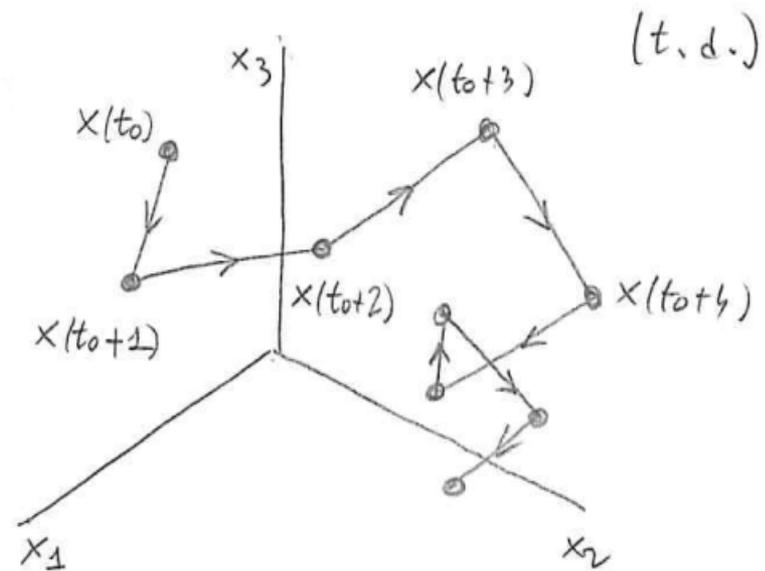
Nota: a t.c. il vettore  $\dot{x}(t)$  (disegnato a partire dalla punta del vettore  $x(t)$ ) è tangente alla traiettoria nel verso di avanzamento del tempo e rappresenta il vettore "velocità" con cui si muove il punto di stato
