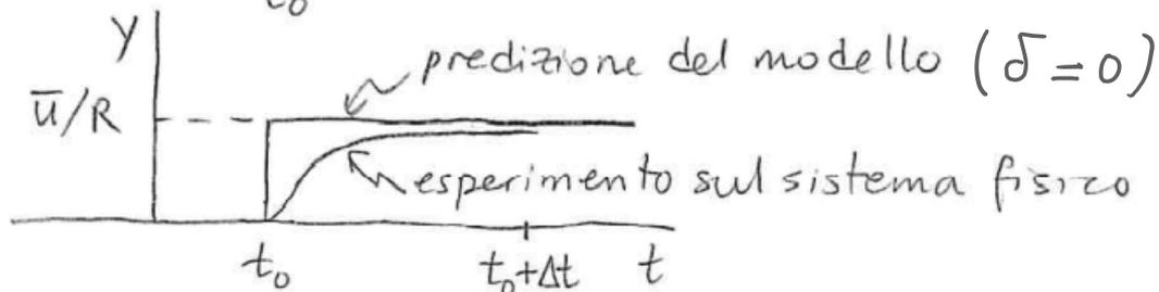
ESEMPIO DI MODELLO DINAMICO (a t.c.): un serbatoio ( $m = p = 1$ )
