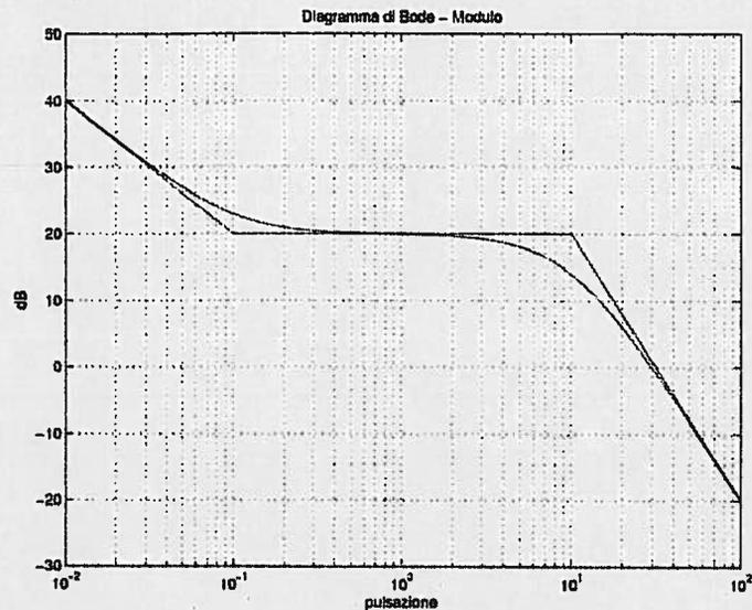
Si è inoltre rilevato che lo sfasamento introdotto dal sistema tende a  $-\pi/2$  per  $\omega \rightarrow 0$  e a  $-\pi$  per  $\omega \rightarrow \infty$ .
