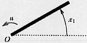
a) Indicando con  $x_1$  e  $x_2$  rispettivamente la posizione e la velocità angolare del braccio, con  $J$  il suo momento d'inerzia, con  $h$  il coefficiente d'attrito e con  $y$  la misura fornita dal sensore, descrivere la dinamica del braccio mediante un sistema dinamico lineare a tempo continuo  $(A, b, c^T, d)$ .
