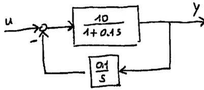
a) Si discutano le proprietà della risposta allo scalino del sistema in figura e se ne tracci un andamento qualitativo.
