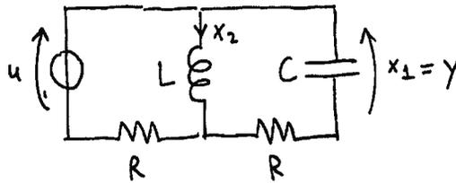
a) Si descriva il circuito mediante un sistema dinamico lineare a tempo continuo, usando le variabili di stato  $x_1$  e  $x_2$  in figura.
