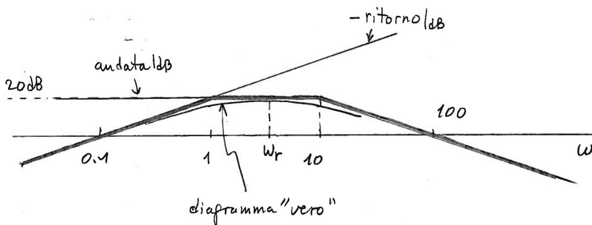
c) Sì,  $\omega_r$ , compresa tra  $\omega=1$  e  $\omega=10$ , dove è massimo il modulo della risp. in freq.
