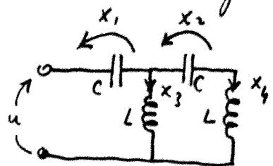
Si dica se è possibile applicare alla rete una tensione  $u(t)$  opportunamente variante nel tempo in modo da ottenere in tempo finito una qualsiasi distribuzione di cariche nei condensatori e induttori, partendo con rete initialmente scarica.
